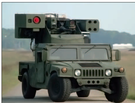
2KW YAG laser testoval Boeing instalovaný na 4x4 HMMWV Avenger na Redstone Arsenal v Huntsville
